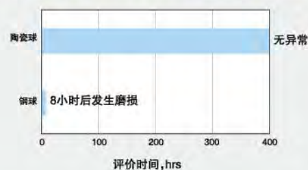
采用不同材质的球进行微动磨损性能评价 400小时耐久试验
